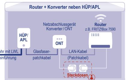
**V3) Der HÜP/APL befindet sich nicht an der Hauseinführung, sondern soll in einem anderen Raum montiert werden. Der Glasfaser-Router befindet sich direkt neben dem HÜP/APL.**
