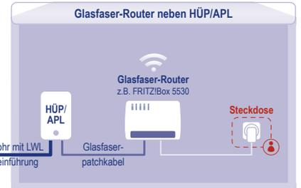
**V2) Diese Variante entspricht Variante 1, jedoch hat der gewünschte Router keinen direkten Glasfaser-Anschluss. Der Router und das Netzabschlussgerät befinden sich direkt neben dem HÜP/APL an der ebenerdigen Hauseinführung.** Es ist keine interne Verkabelung notwendig. Das Netzabschlussgerät und der Router benötigen einen kundenseitig zu stellenden Stromanschluss (230V-Steckdose).
